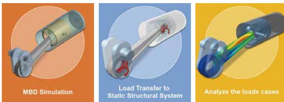
Multi-body Dynamics For ANSYS提供“Load Transfer”功能，将机构中零部件在运动过程的载荷自动转移至FEA模型。适用于General Joints/Force，可根据需要有选择性地指定需要映射载荷的零部件，根据MBD分析结果有目的地指定映射载荷的时刻。Load Transfer之后，在Project Schematic视窗中自动创建FEA分析的Case，自动建立MBD分析与FEA分析之间的数据连接关系，实现机构的功能分析与机构中结构的强度分析无缝集成。
